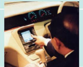
車載された世界初のGPSカーナビゲーションシステム
