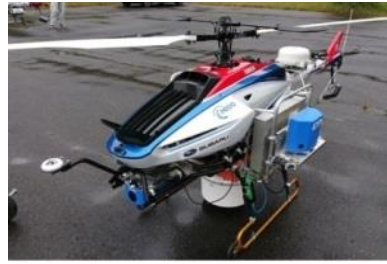
ヤマハ発動機/Fazer R G2 (W3700×H1200mm、110kg)
