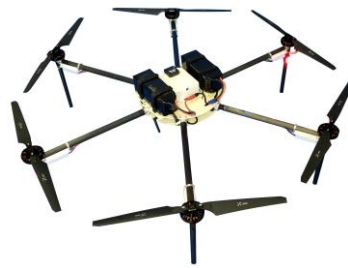
双葉電子工業／FMC-02 (W700×H400mm、3kg)
