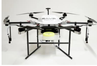
イームズロボティクス/エアロスプレイヤーAS5 (W1060×H300mm、15.9kg)
