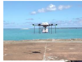
UAVはLTEネットワークを用いて 起動し、自動航行する
