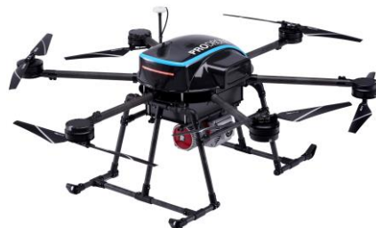
プロドローン/PD6B-type2_01 (W2000xD2000xH500mm、50kg)
