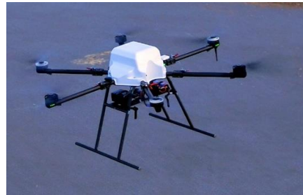
スカパーJSAT/FH1440 (W1440×H720mm、17.1kg)
