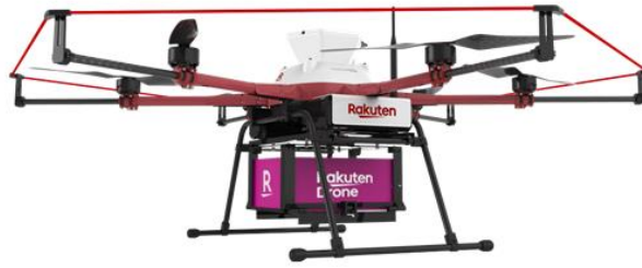
楽天(株)ドローン専用機体「天空」 (W1173×H542mm、6.6kg)
