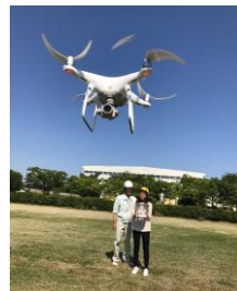
DJI/Phantom4 pro (対角寸法 350mm、1.4kg)
