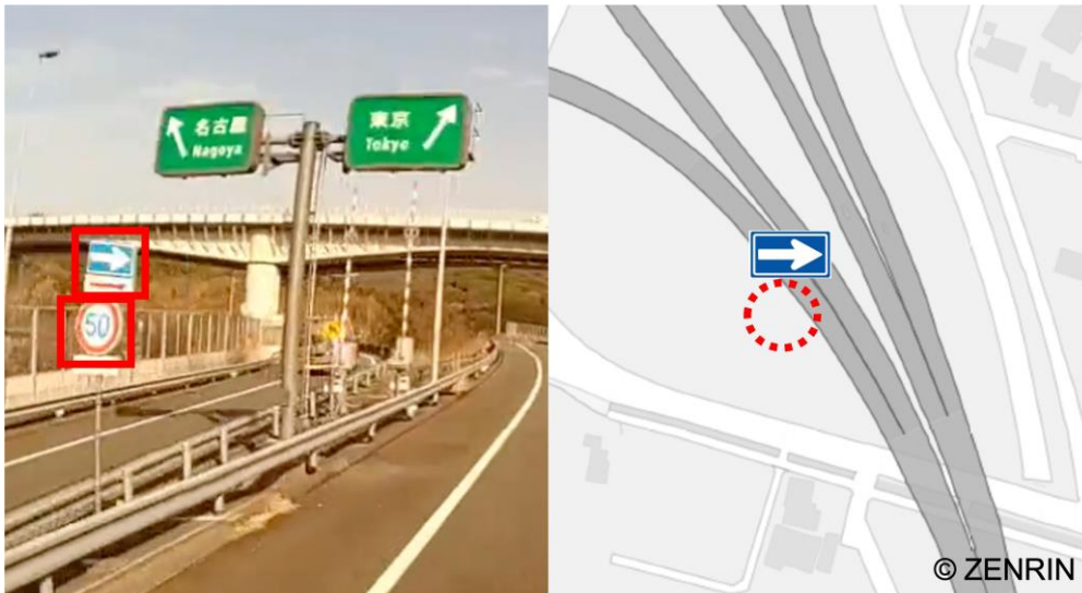
▲高速道路の規制標識を画像認識（左）し、地図上該当箇所(右)と比較し差分を検出
